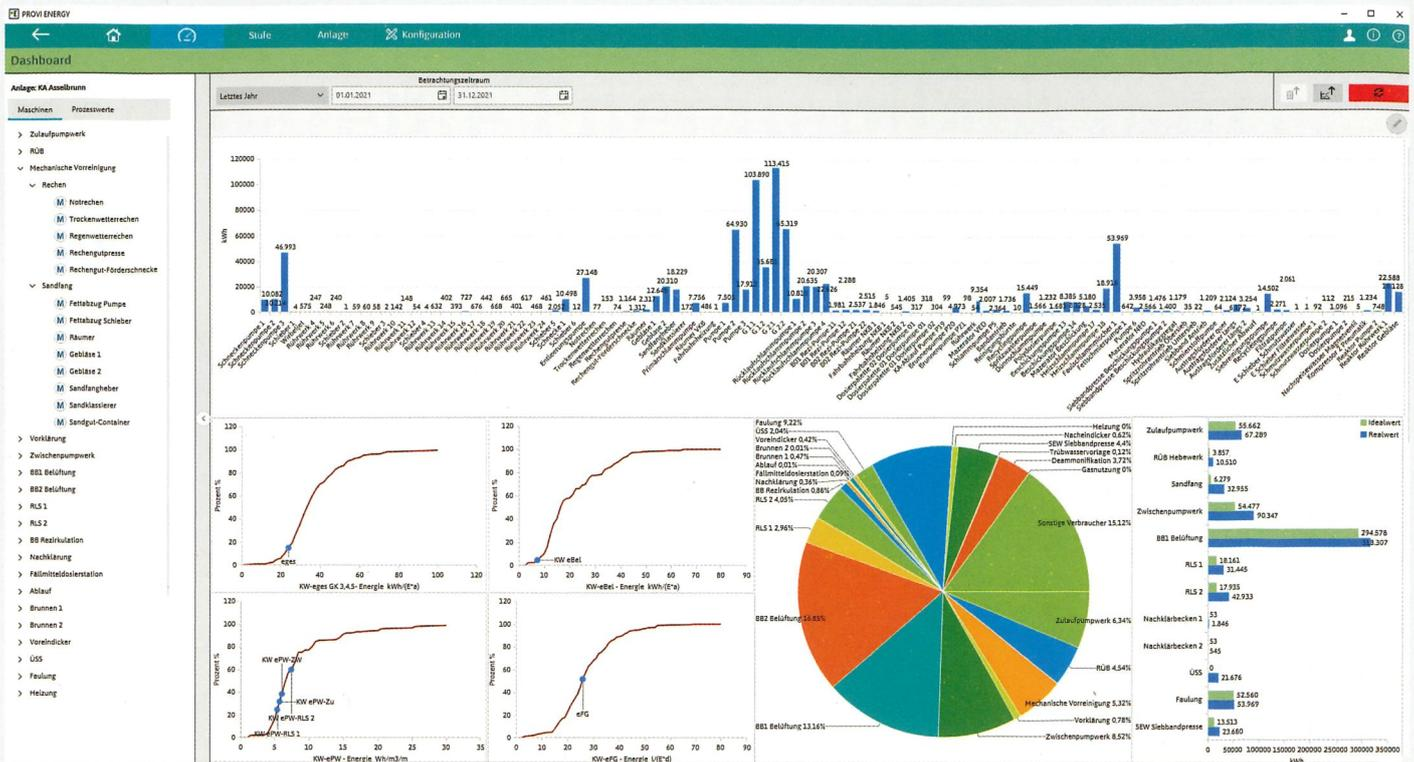
Bild 3 Übersichtliche Darstellung auf dem Dashboard: Kennwerte, Stromverbrauch der Stufen und Maschinen, Idealwerte und Potenziale
