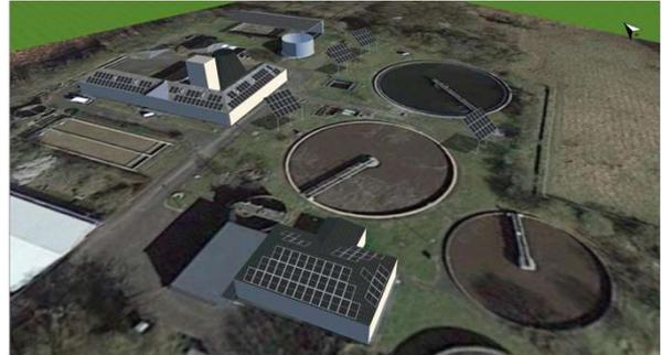
Im Beispiel der Kläranlage Ruwer werden nur 61.000 von 145.000 kWh/a direkt verbraucht. Die Batterie kann weitere 31.500 kWh speichern und wieder zur Verfügung stellen. Hier erweist sich die Batterie mit einer Größe von 136 kWh als wirtschaftlich.
