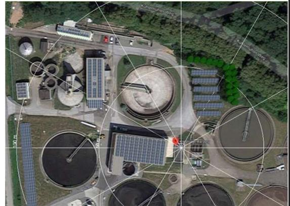
Die Kläranlage Warburg soll eine PV mit 266 kWp erhalten. Von den dann erzeugten 207.000 kWh werden 162.000 kWh direkt in der Anlage verbraucht. Es wurde diskutiert, hier eine Batterie mit einer Kapazität von 230 kWh mit vorzusehen. Aus dieser Batterie werden aber nur 28.000 kWh/a an die Kläranlage wieder abgegeben. Da hier der größte Teil des erzeugten PV-Stromes direkt verbraucht werden kann, ist eine Batterie nicht wirtschaftlich.
